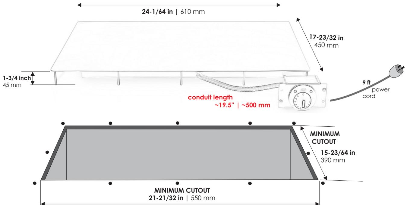
▶▶ Kontroll-Element MUSS FIXIERT SEIN. Alle Kabel müssen sicher verstaut und befestigt sein, nicht baumeln.
